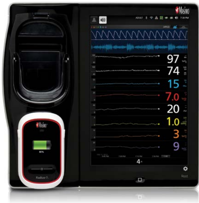
Ogni Radius-7 è dotato di due moduli ricaricabili hot-swap.
